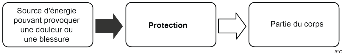
Figure 2 – Modèle en trois blocs pour la sécurité
