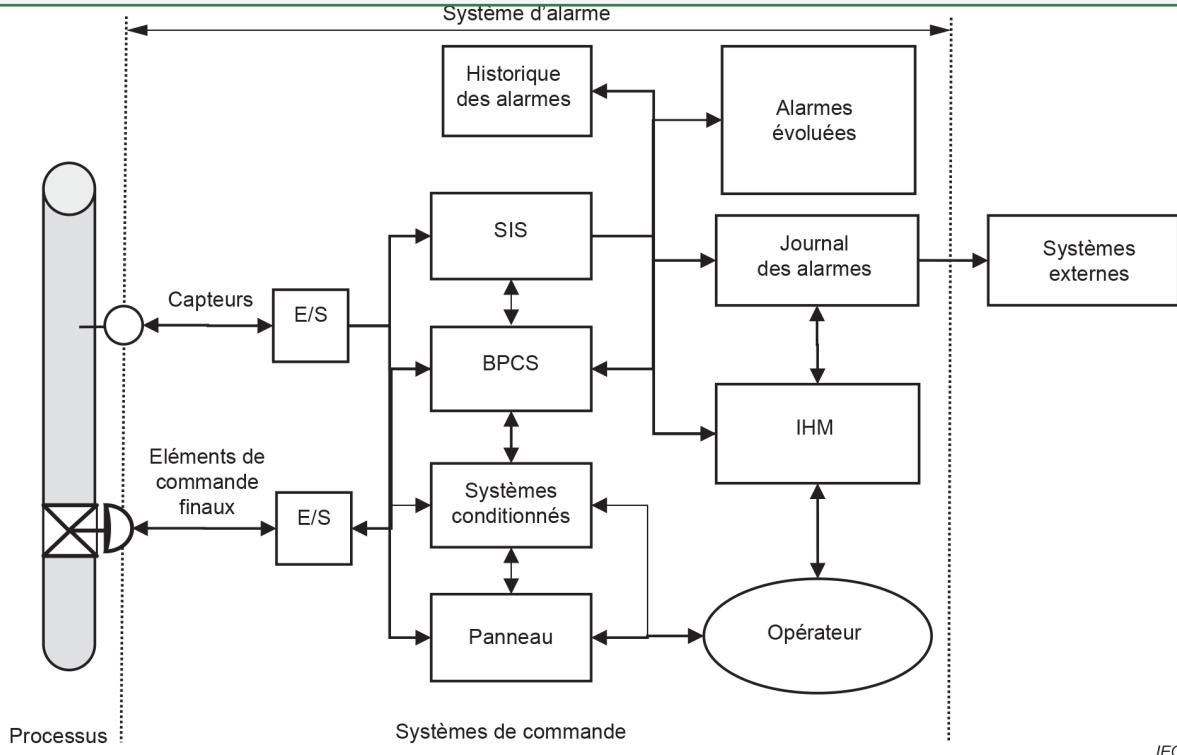
NOTE 1 Les systèmes conditionnés (par exemple machines frigorifiques) peuvent être inclus dans le système de commande.
